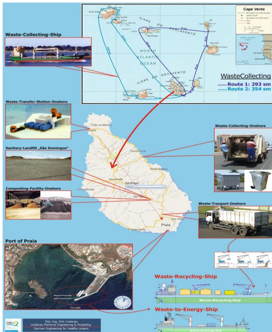
Das Lindenau WRS-System: das erste nachhaltige schiffsbasierte Abfall-Management-System. Einsatz am Beispiel der Kapverden
